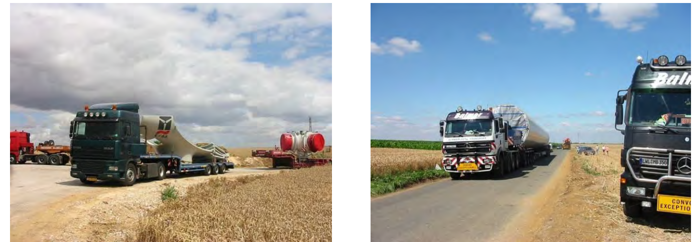
Photographie 4. Transport des pâles (Source : Enertrag)
